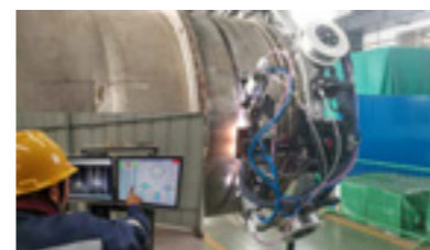
使用窄间隙 TIG 焊接机器人进行主管道模拟件接头焊接
